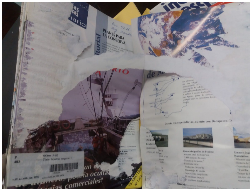
Obra de papel couché danificada pela umidade. Neste caso as folhas aderiram e ao tentar separá las o papel rasgou.
